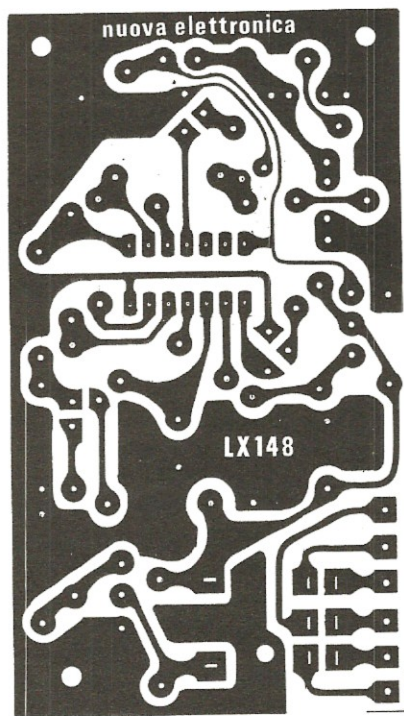
Fig. 2 Circuito stampato a grandezza naturale visto dal lato rame.
